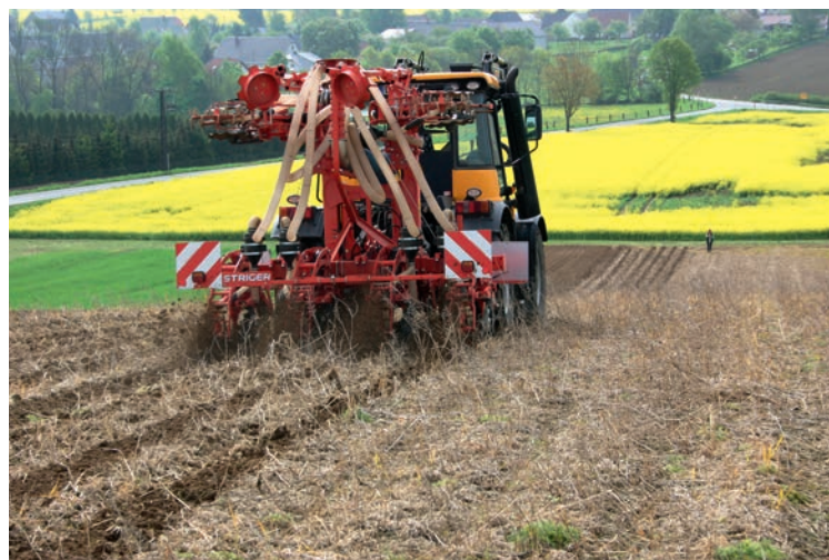
Durch Streifenbearbeitung (hier vor der Maisaussaat) kann ein mit Direktsaatflächen vergleichbarer Erosionsschutz erreicht werden.
