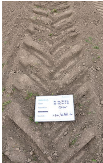
Die Spurtiefe ist abhängig vom Reifendruck.
